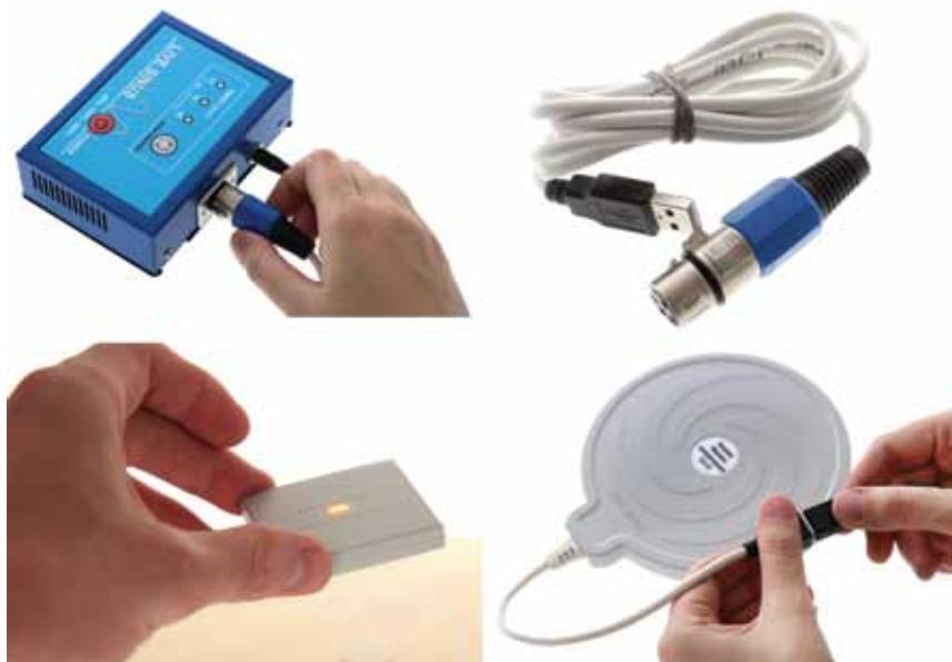
Индикатор поля в этом режиме светится ярко над катушкой (см. рис.), интенсивность и дальность свечения индикатора зависит от заданного на генераторе уровня мощности (выходного тока).
