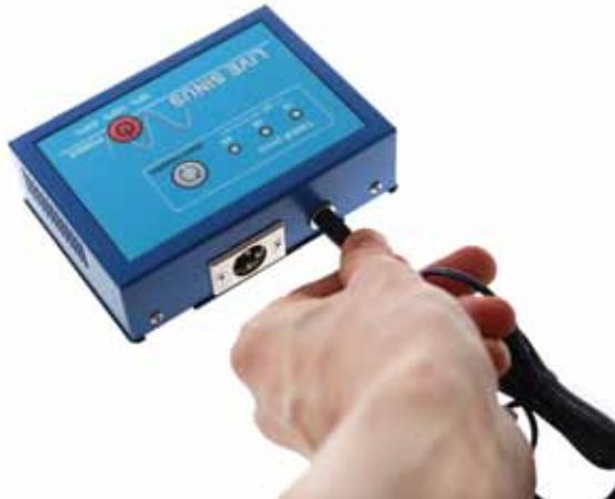
а) XLR разъем кабеля подключаем к соответствующему разъему генератора
